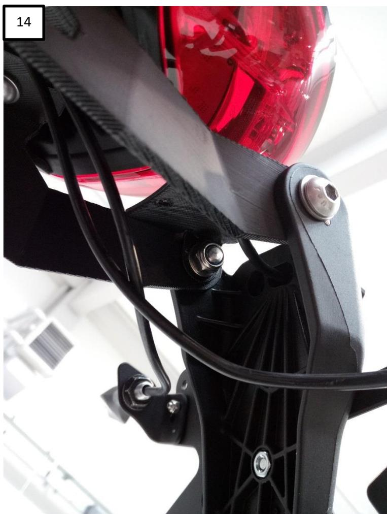
14. Controllare il corretto fissaggio di tutta la viteria, eseguire le connessioni elettriche utilizzando connettori adeguati e a norma. Controllare infine il corretto funzionamento dei dispositivi luminosi.
