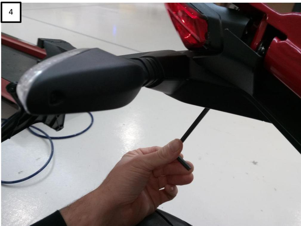
4. svitare le 2 viti che sostengono il portatarga, si trovano nascoste all'interno del vano apertosi
