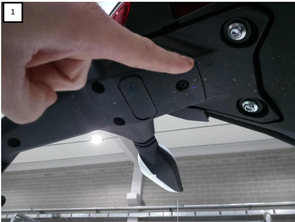
1. svitare le due viti del sottocoda indicate in figura qui sopra
