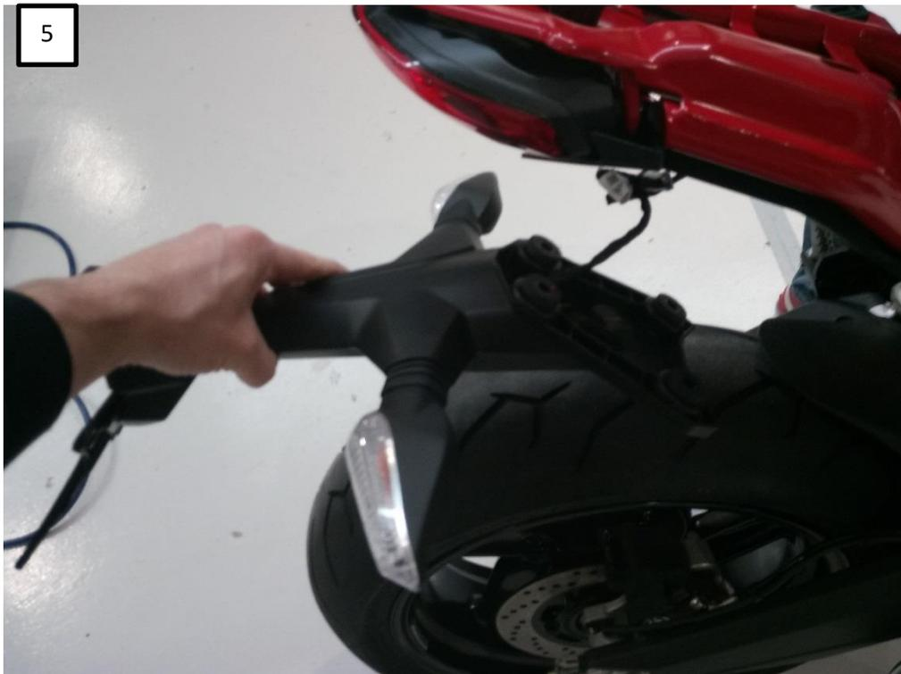
5. staccare il portatarga di serie e scollegare il cablaggio elettrico (a chiavi disinserite)
