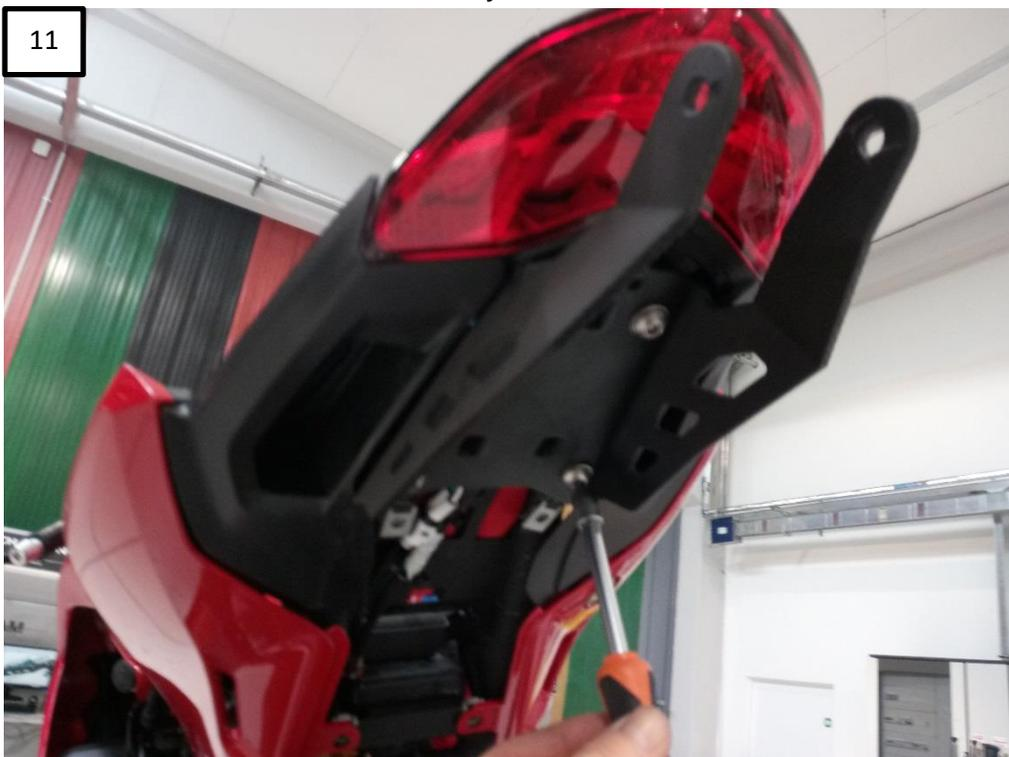
11. appoggiare il nuovo portatarga al telaio e avvitare le 4 viti.
